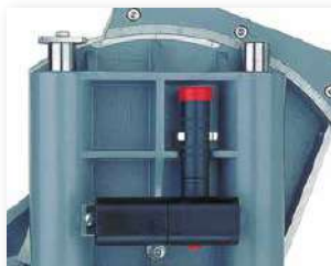
Pour réaliser des entailles en biais par rapport au chant: inclinaison jusqu'à 45° des deux côtés.
