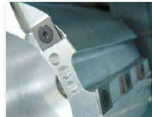
Le nouveau porte-outil avec ses fers réversibles au carbure pour un enlèvement extrême des copeaux avec une circulation optimale des copeaux.
