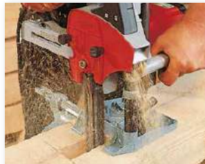
La LS 103 Ec et le support de guidage FG 150 pour des profondeurs de mortaises pouvant atteindre 140 mm.
