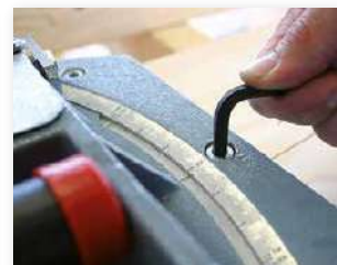
Le dispositif peut être incliné jusqu'à 45° des deux côtés.
