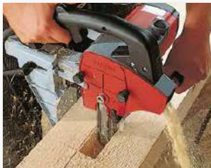
Mortaises de différentes tailles (jusqu'à 100 mm) réalisées avec la LS 103 Ec.
