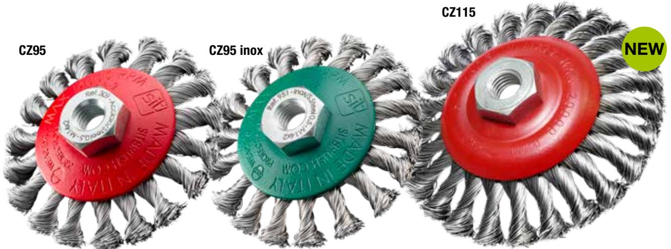
La forme conique rend ces brosses aptes aux travaux "de coupe" sur des surfaces irrégulières, avec des bords, profils et fissures. Les mèches torsadées en font une brosse agressive. La version avec 24 mèches assurent de meilleures performances grâce à une plus grande zone de brossage en contact direct avec la surface.
