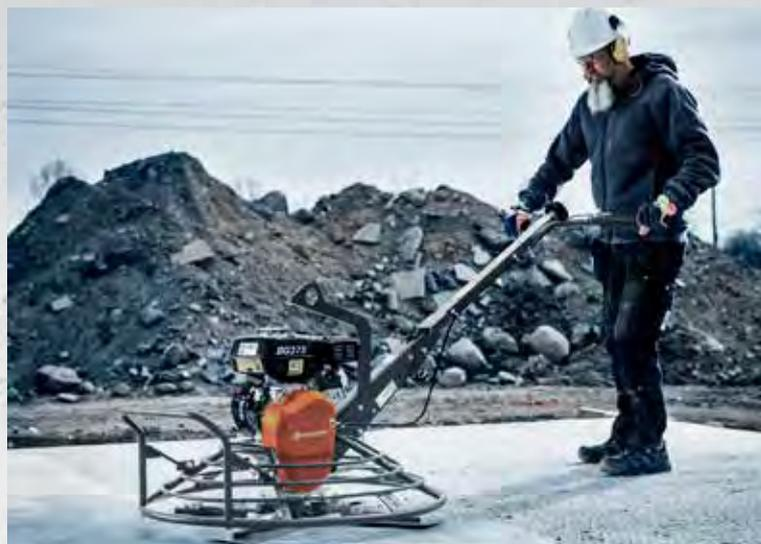
**PALE FLOTTANTE EN ACIER** Les pales flottantes sont utilisées pour lisser la surface du béton dans la phase initiale de finition du béton. Les pales flottantes Husqvarna ont une surface presque plate, créant un effet d'aspiration entre la pale et la surface. Cela déplace le béton d'une position supérieure à une position inférieure sur la dalle.
