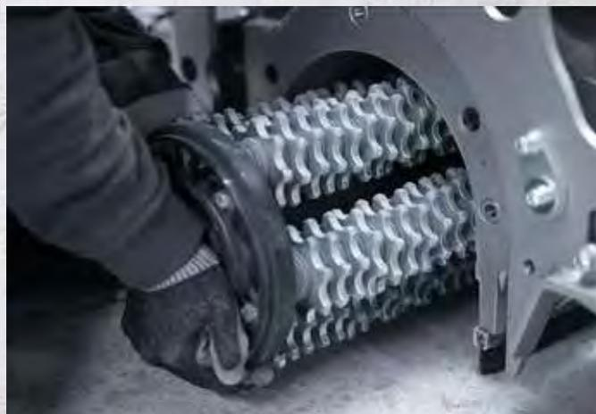
**CHARGEMENT LATÉRAL DU TAMBOUR** Les raboteuses Husqvarna sont spécialement conçues de sorte que le tambour puisse être facilement retiré par le côté, sans avoir à déplacer la machine.
