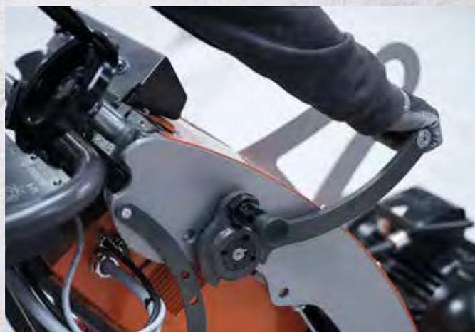
**RÉGLAGE PRÉCIS DE LA PROFONDEUR** La profondeur de travail du tambour de la rainureuse est facilement réglable et précise au millimètre près. Cela élimine toute détérioration dans le sol. Toutes nos scieuses sont conçues de sorte que la totalité du poids de la machine soit centré afin de créer une force verticale maximale sur le tambour rotatif.
