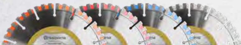
**SPEED Pont** Les disques Elite-Cut S 35 ont maintenant un pont-raccord entre les segments. Ce système permet d'accélérer la vitesse et la fluidité du sciage par un frottement latéral réduit, un meilleur refroidissement et une évacuation plus efficace de la poussière. La couleur du pont-raccord indique le matériau pour lequel il est prévu.
