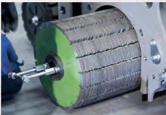
**RÉGLAGES DU TAMBOUR** Les scieuses utilisent un tambour équipé de disques diamantés. En ajustant le nombre de disques et d'entretoises, il est possible de créer une large gamme de tranchées de 1 à 33,5 cm de large.
