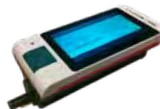
5 Appareil de mesure de la rugosité, Marsurf PS10
