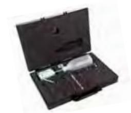
6 Test de pénétration, Karsten Pipe test kit
