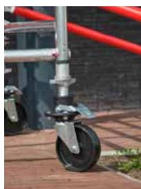
Roues avec double freins (Ø 200 mm) avec grosse pédale de frein. Facile à déverrouiller à pleine charge et réglables jusqu'à 25 cm.
